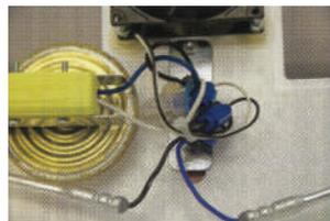
Torsader les fils sur eux-mêmes et les fixer en place à l'aide de serre-câbles. Brancher l'incubateur dans une prise murale pour vérifier qu'il fonctionne correctement. Le ventilateur souffle vers le haut, loin des œufs
