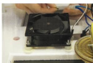
Placer un écrou sur chacune des quatre vis. Serrer jusqu'à ce qu'ils soient bien solides
