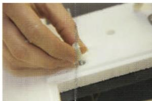
Retourner le couvercle de l'incubateur, installer une douille en plastique sur chaque vis et les enfoncer dans les trous
