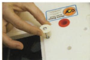
Placer quatre vis avec une rondelle chacune à travers la face supérieure du dessus de l'incubateur
