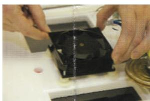
Installer le ventilateur sur les vis avec le côté de l'étiquette tourné vers le corps du couvercle de l'incubateur, les fils du ventilateur menant vers le cordon d'alimentation
