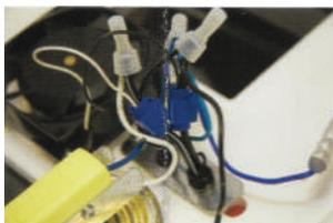
Connecter l'autre fil du ventilateur à l'autre fil du cordon d'alimentation de la même manière, puis clipser le couvercle en plastique fermé
